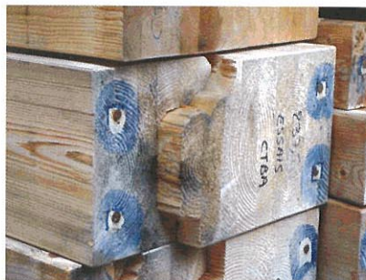
PROBETAS ENSAYADAS DE VIGAS CON ARMADURA DE REFUERZO
