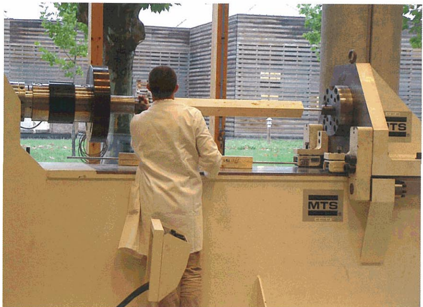
ENSAYO DE RESISTENCIA DEL ANCLAJE DE LA BARRA EN TRACCIÓN
