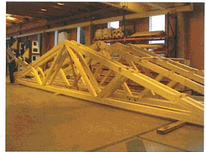
VARIAS CERCHAS PREPARADAS PARA ENSAYO
