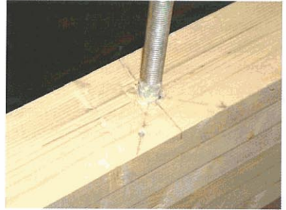
PROBETA CON BARRA DE ACERO ANCLADA EN DIRECCIÓN PERPENDICULAR A LA FIBRA
