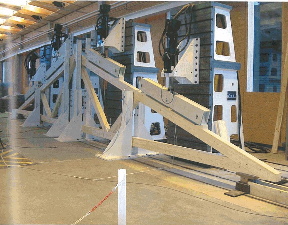
ENSAYO DE CERCHA DE MADERA LAMINADA ENCOLADA
