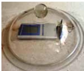
Fotografía 8: Método experimental de la cámara de condensación. Detalle de la burbuja aislada con el higrómetro en su interior
