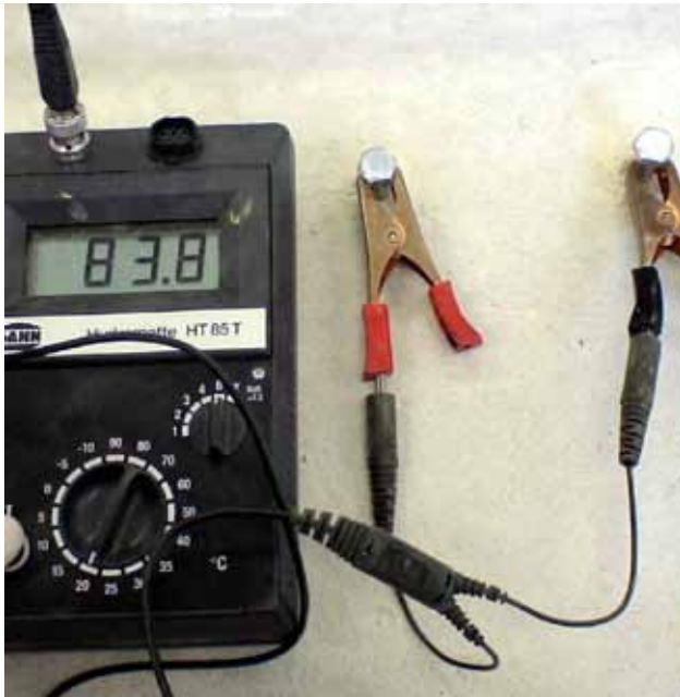
Fotografía 4: Medición con tirafondos de cabeza hexagonal en el método de resistencia eléctrica
