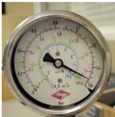
Fotografía 6: Detalle de la escala de medición del higrómetro de carburo
