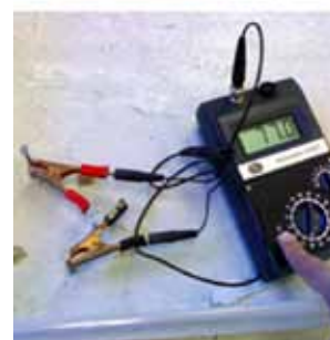
Fotografía 3: Fases en el método de resistencia eléctrica. Realización de los orificios, introducción de la pasta de contacto, colocación de electrodos y lectura.
