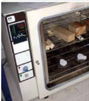
Fotografía 2: Fases en el método de desecación en estufa Extracción de la muestra, pesado y desecación
