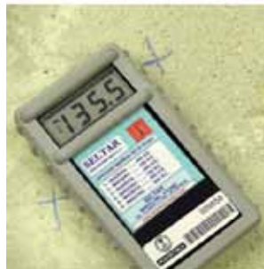
Fotografía 7: Algunos ejemplos de medidores de contacto por radiofrecuencia o capacitivos
