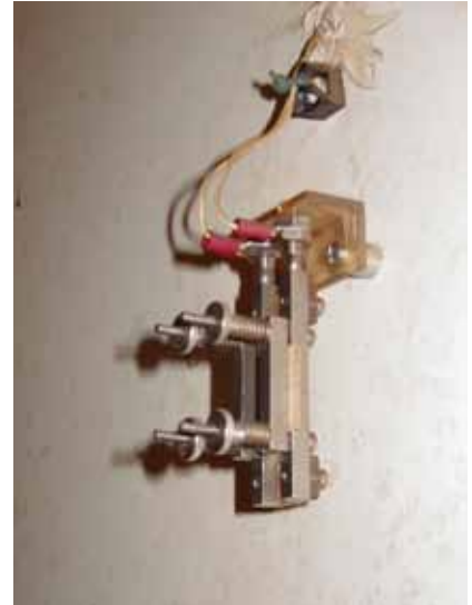
Sonda de Humedad de Equilibrio (Placa de madera de limba)
