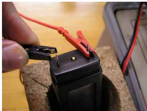
Calibración de equipos con clavos fijos al aparato de medida (foto INIA)
