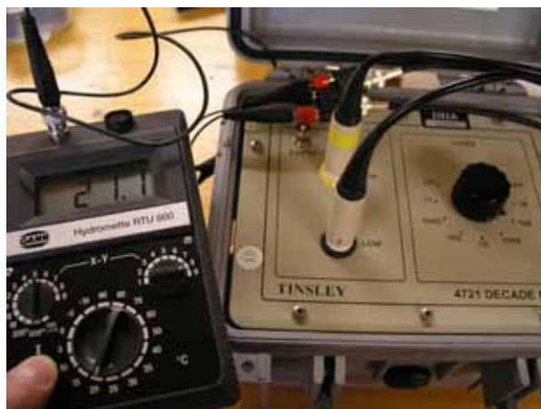
Calibración de un xilohigrómetro de resistencia empleando una caja de décadas de alto valor y las mejores curvas Resistencia-humedad (foto INIA)
