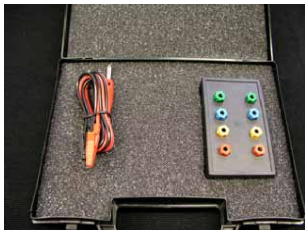
Caja de resistencias de cuatro polos de uso industrial (foto INDITECMA)
