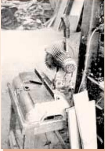
Es una máquina utilizada para el corte de madera a un ángulo determinado entre 45° a derecha e izquierda del plano normal de contacto del disco con la madera, pudiendo cortar asimismo a bisel.
