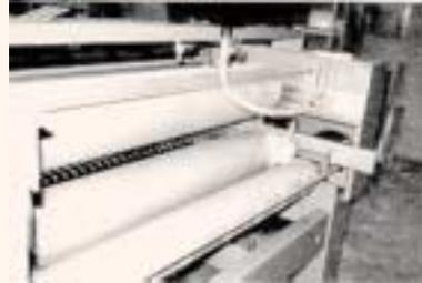
**CILINDROS ABIERTOS PARA LA LIMPIEZA. DETALLE DEL CABLE DE ACCIONAMIENTO DEL PARO DE EMERGENCIA A AMBOS LADOS DE LA MÁQUINA**
