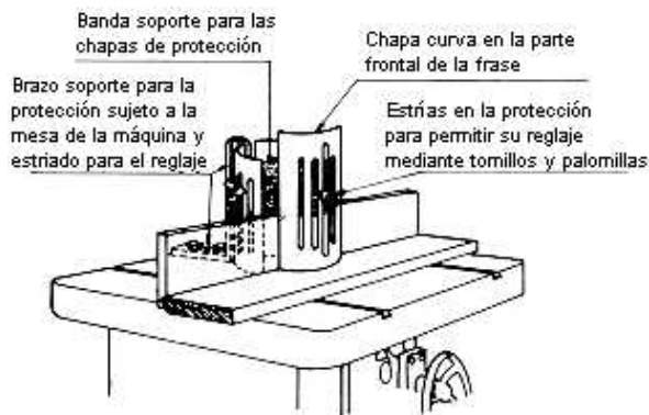
Fig. 19: Protección tipo "jaula" adaptado a la mecanización de piezas rectilíneas (Fuente: Department of Labour, New Zeland)
