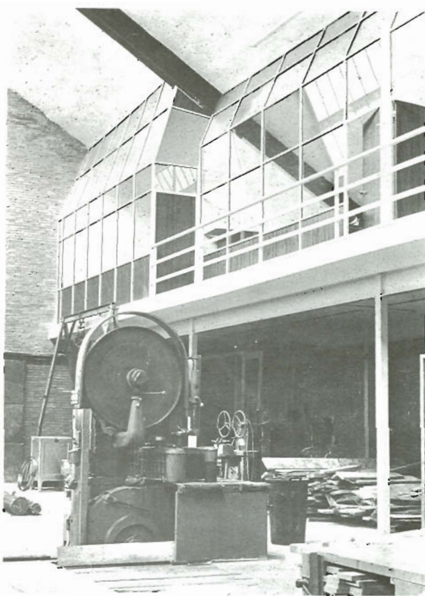
Sierra de desdoblado, perteneciente a la línea de aserrado. En la segunda planta, recientemente edificada, se encuentra el Laboratorio de física, adhesión y recubrimientos superficiales.
