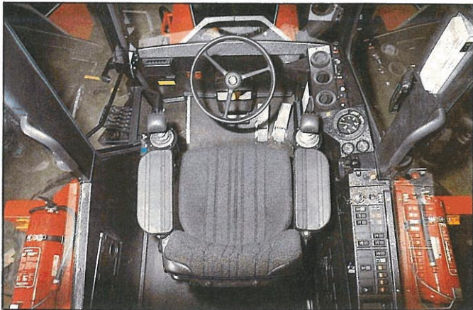
Fig. 3.—Detalle del sillón y de los mandos de control integrados en los brazos del mismo.
