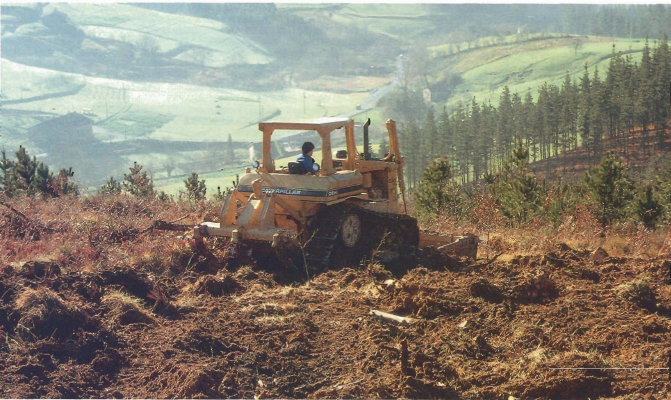
Tractor forestal Caterpillar D6H de 165 HP de potencia.
