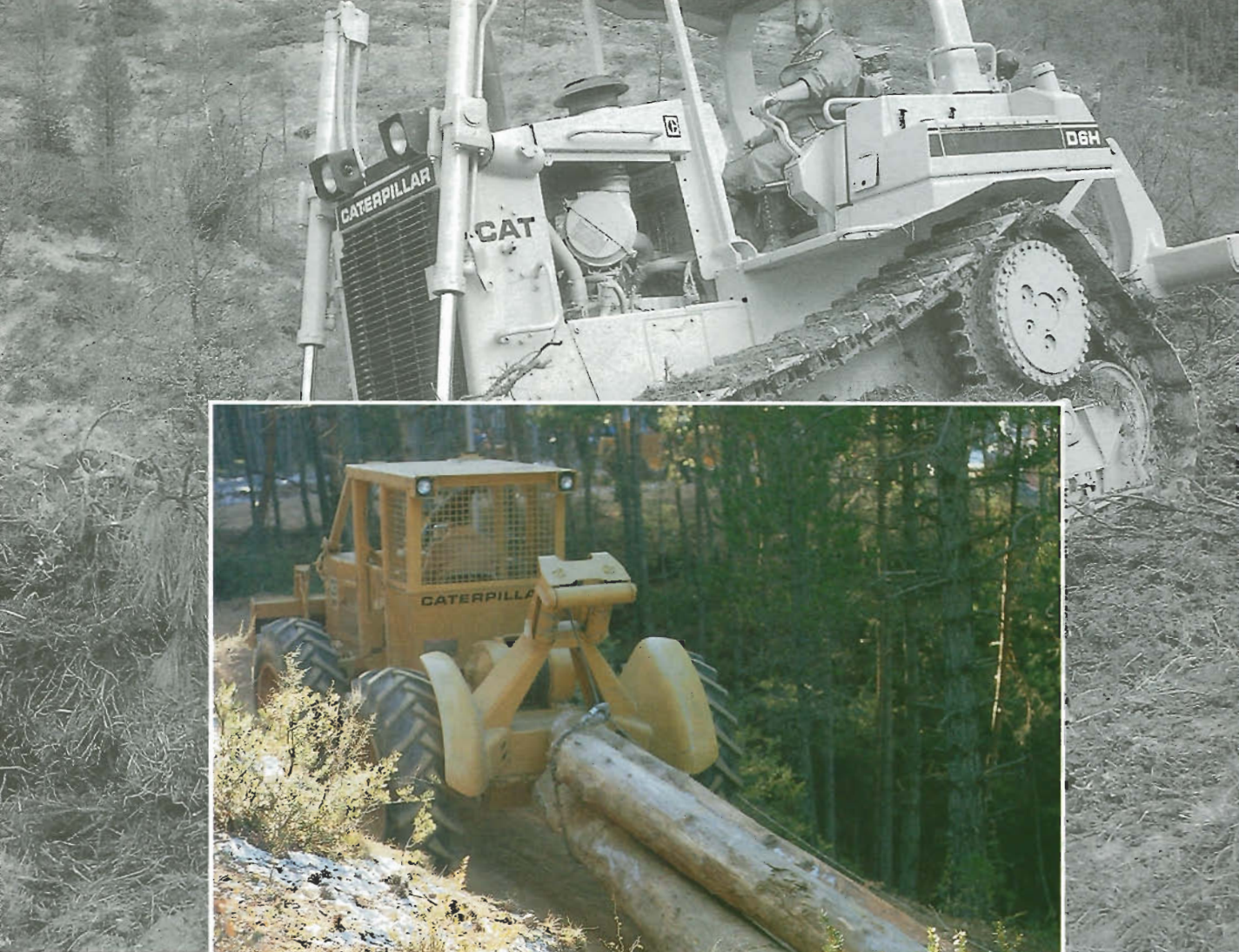
Tractor forestal Caterpillar D6H de 165 HP de potencia.
