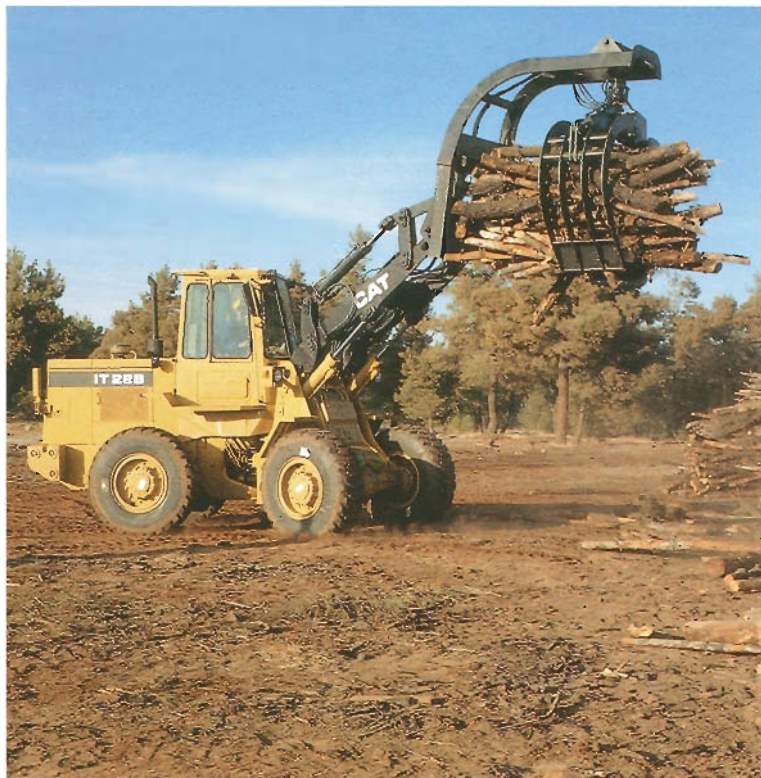
Cargadoras industriales IT Caterpillar. Pueden equiparse con una gran variedad de implementos forestales, realizando el cambio de los mismos en menos de 30 segundos y sin bajarse de la cabina.
