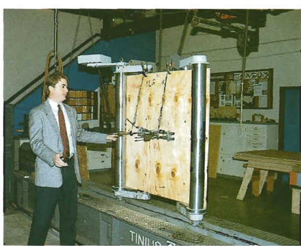
Steve Zylkowski explica el funcionamiento del ensayo de flexión pura en tamaño real.
