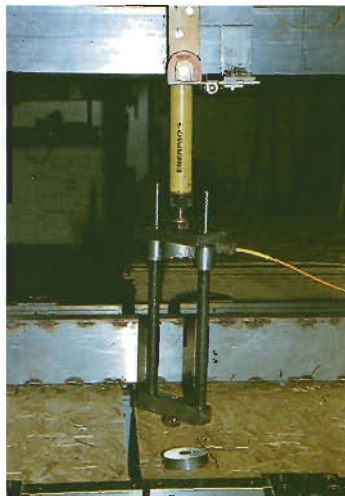
Ensayo de flexión con carga excéntrica
