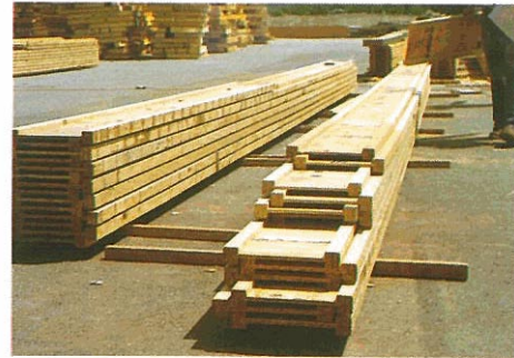
Viguetas de forjado. Construcción mixta de tablero y LVL.
