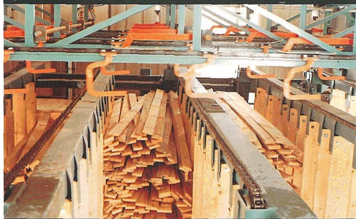
Vista parcial del sistema de transporte, clasificación y boxes de asilado.
