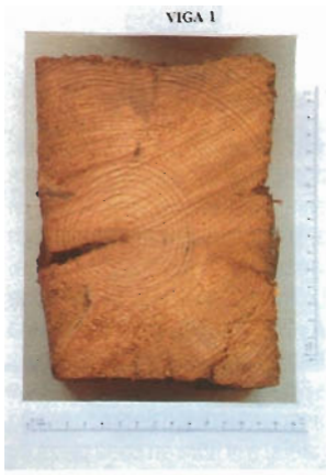
Sección transversal de una viga de la serie A.
