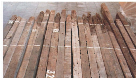
Vigas de forjado marcadas
