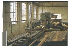
4. Sierras Gemelas o Enfrentadas (3). Consisten en dos sierras de cinta verticales con volantes de 1,30 metros de diámetro. Un dispositivo electrónico separa dos volantes que componen una sierra, de los otros dos, dejando la anchura de corte deseada entre las dos sierras de cinta.
