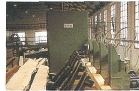
6. El tocho central procedente de las gemelas pasa al cabezal, máquina de concepción clásica, aunque de fabricación moderna
