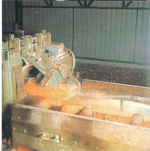
4.- Aserradero Etorki. Alimentación de troncos a la línea de fabricación.
