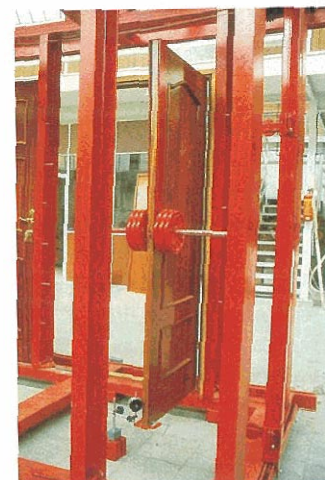
Ensayo de carga vertical
