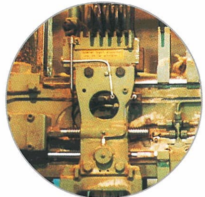
Hojas desplazables en una sierra alternativa múltiple de última generación (Fuente: Simon Möhringer GmbH)
