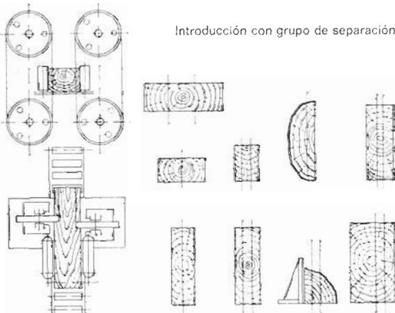
La firma Canali ha desarrollado un elemento para serrerías compuesto por dos sierras de cinta enfrentadas, que permiten el canteado de troncos como paso previo a su transformación en tablas. Es de gran utilidad en fábricas de tabla o tablilla para embalajes.
