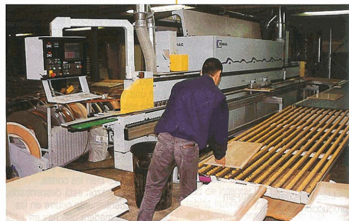
APLACADO DE PIEZAS EN LA MÁQUINA KL 77-S2
