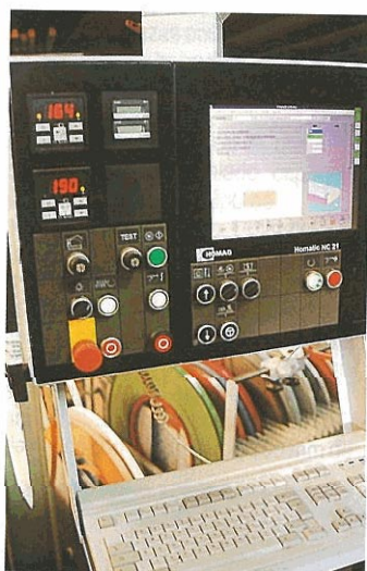
CONTROL HOMATIC. AL FONDO ALMACÉN DE BOBINAS DE CANTOS
