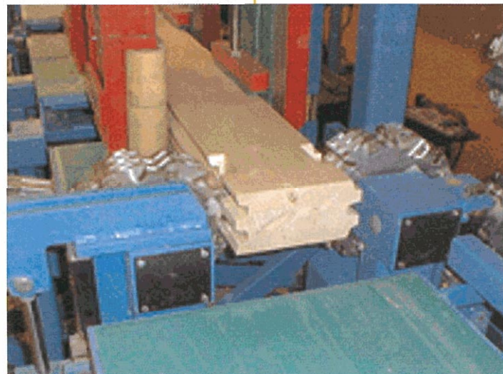
FRESADO PARA ENSAMBLE DE PIEZAS EN LA CONSTRUCCIÓN BLOCKHAUS. OPERACIÓN VERTICAL
