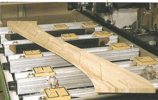
ELABORACIÓN DEL MÁSTIL LATERAL DE UNA ESCALERA
