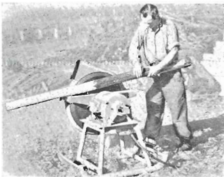
Fig. 2. Descortezado por medio de cuchillas situadas en un disco que gira. Modelo ASEI. Bezner
