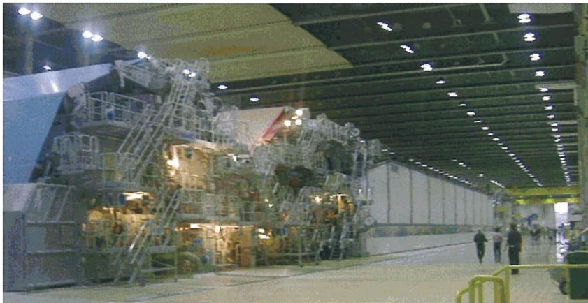
MÁQUINAS DE PRECISIÓN ASOMBROSA CAPACES DE PRODUCIR UNA CAPA DE PAPEL DE 11 METROS DE ANCHO A UNA VELOCIDAD DE 100 KM/ H
