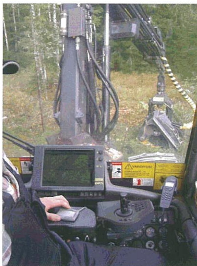
CABINA DE PROCESADOR FORESTAL CON GPS Y PLANO DIGITALIZADO DE LA PARCELA: TECNOLOGÍA Y ERGONOMÍA PARA UN TRABAJO EFICIENTE
