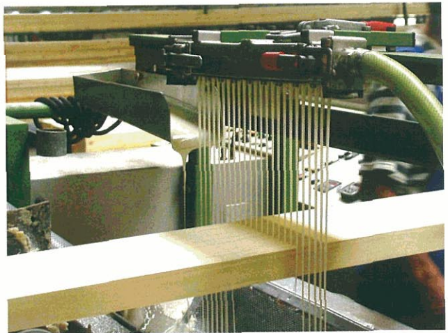
Encolado de las láminas
