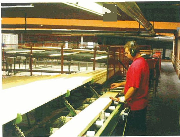
Clasificación de la madera antes de su unión por empalmes dentados
