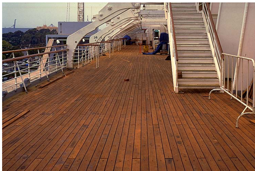
La idea de las tarimas al exterior proviene de las cubiertas de los barcos. La de la imagen es de teca.
