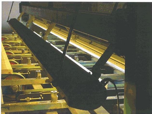
Foto 7 Clasificación de la madera por análisis de la imagen
