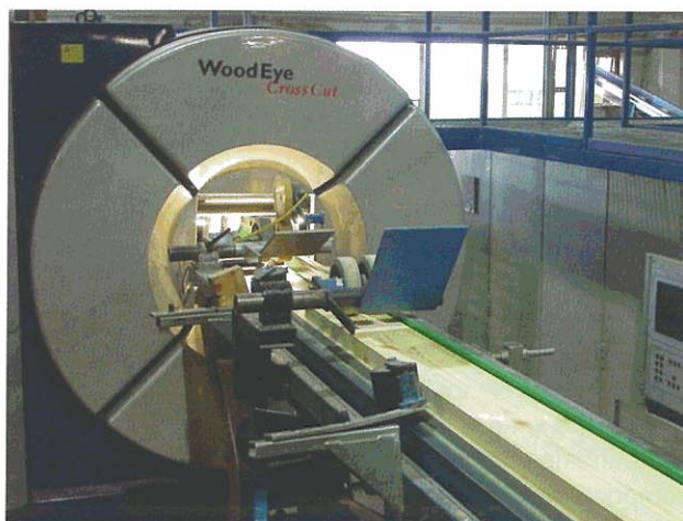
Foto 8 Reconocimiento de defectos en la línea de saneado
