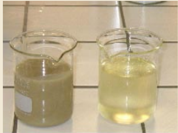
La muestra de barniz de la izquierda contiene un alto contenido de sílice común; a la derecha un barniz formulado con sílices nanométricas.
