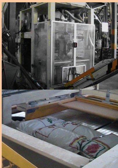
Figura 5. Planta de envasado de Pelets Ecoforest. S.A. Máquina de llenado (1). Bolsas de pelets de 15 kg de peso (2).
