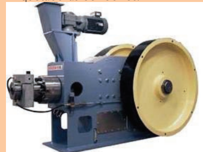
Fig. 1. Briquetado: prensa de pistón mecánica. Fuente: www.bogma.com (2001).
