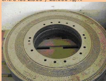
Figura 2. Matriz plana utilizada en las máquinas peletizadoras de la fábrica Ecoforest S.A. Fuente: Autor (2004).
