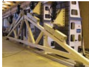
Ensayo de cercha de 14 m
