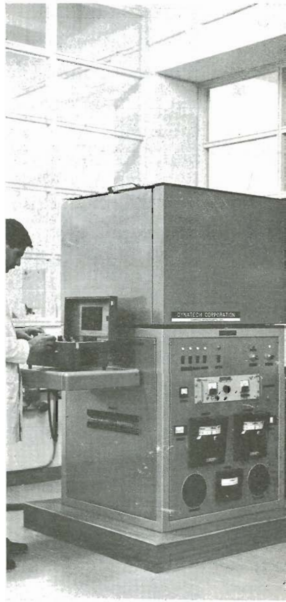
Fig. 1.— Equipo medidor de la conductividad térmica del aglomerado de corcho para aislamiento. — DYNATECH Corporation (U. S. A.)
