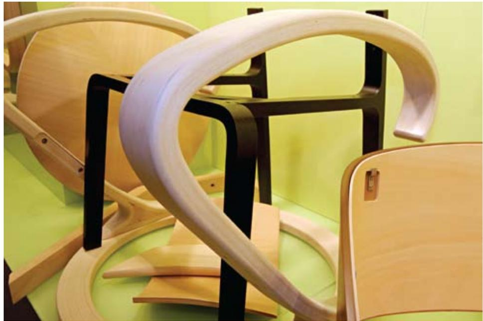
tablero revestido, como si de madera natural se tratara. Sigue habiendo innovaciones en la utilización de chapa para revestimiento de tableros. Los folios de apoyo permiten mayor flexibilidad del material con radios más pequeños y mediante la nueva tecnología de prensado con membrana se puede realizar totalmente el proceso sólo mediante vacío. Ya se encuentran chapas precompuestas a base de listones, para dar al panel revestido apariencia de tablero alistonado auténtico.
