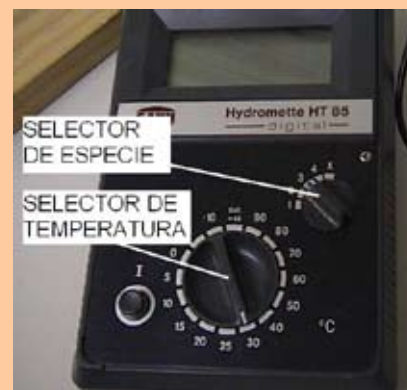
Figura 2: Cuerpo principal del xilohigrómetro de resistencia Gann HT 85
