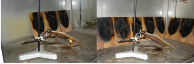
Figura 2: Ensayo de resistencia al fuego.
