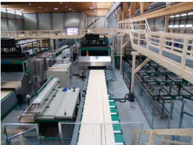
Prensado de vigas con alta frecuencia
