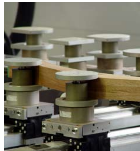
Ventosas de superficie circular, gobernadas por ejes individuales, permiten que cada pieza sea mecanizada por dos caras sin necesidad de moverlas
