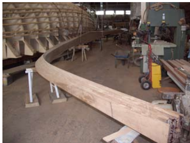
3 El perfilado de la quilla, columna vertebral del barco, puede realizarse con un centro de trabajo de 5 ejes con amplias áreas de trabajo, como el Poseidon de CMS. (foto de la quilla+foto Poseidon de CMS)
