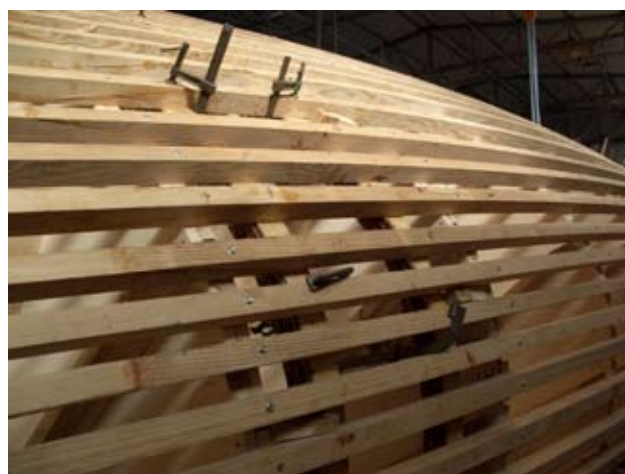
2. Los listones de pino amarillo han sido realizados por una moldurera SCM Superset Class Nt. (foto pino amarillo+foto SCM Superset)
