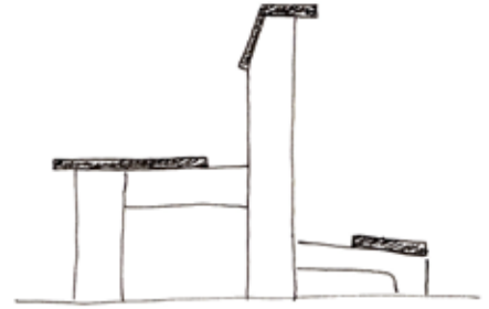
Sección del banco de la iglesia. El pórtilo se va repitiendo invariable extruyendo bancos a medida de la nave.
