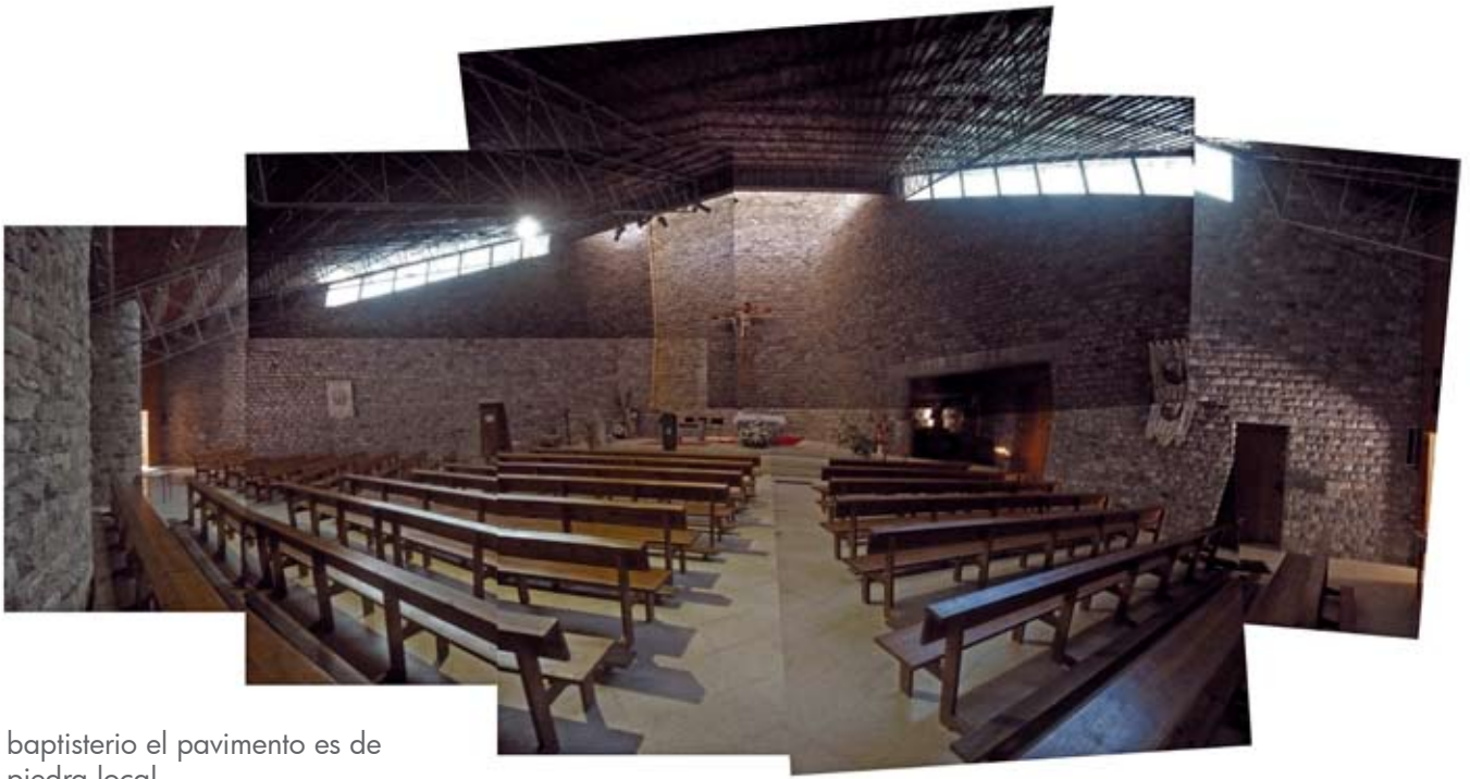
Vista general interior de la iglesia. Bancos paralelos a las correas de la estructura. Jácenas longitudinales disparan la vista hacia el altar. La última no choca con la pared por la ventana corrida. Muros ciegos cierran la vista y el altar se inunda de luz.
