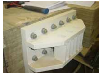
Figura 10 Esquema de la conexión en biela mostrando las barras encoladas (A) y los tornillos preajustados (B).
