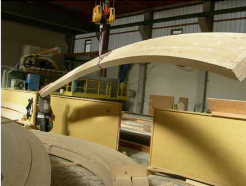
Una pieza curva abandona el portal de mecanizado CNC
