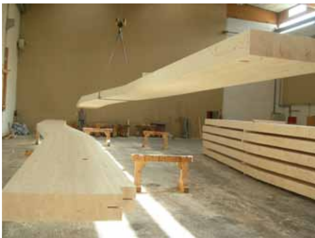
Fabricación de piezas de cualquier forma y longitud hasta 40,5 m
