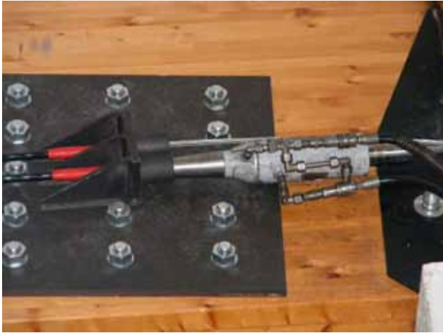
Figura 12: Detalle del gato de tesado y elemento desviador de los cables. El diseño final del desviador fue realizado por el departamento técnico de Mekano 4.
