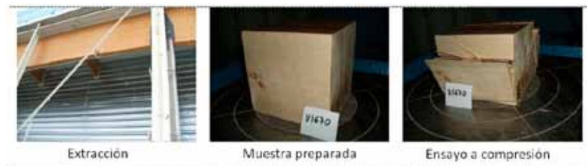
Figura 5: Ensayo de la madera existente para determinar su calidad
