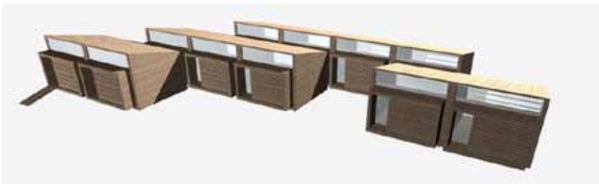
Módulos de día. Diferentes distribuciones para la zona de día (cocina + salón) de parte de una vivienda unifamiliar de mayor dimensión. Módulos de noche con habitación principal y secundaria.
