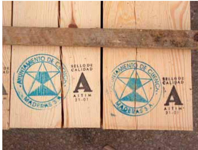
Figura 2. Detalle de Sello voluntario AITIM y de marca del aserradero
