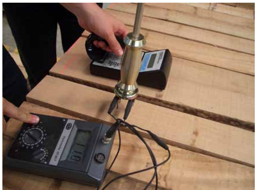
Figura 3. Medición de la humedad de la madera con xilohigrómetros de resistencia (izquierda) y capacitancia (derecha)
