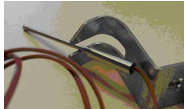
Figura 5. Termorresistencia Pt100 de medición de temperatura de madera y útil de extracción
