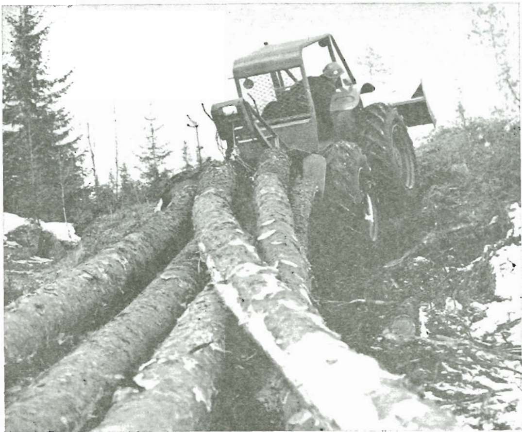
Figura 2.—Tractor arrastrador de troncos articulados (Kockumm - Suecia)
