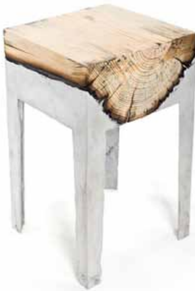
Madera y aluminio. Wood casting, por Hilla Shamia. Se va vertiendo el aluminio caliente sobre el contramolde y la madera, que se quema parcialmente.
