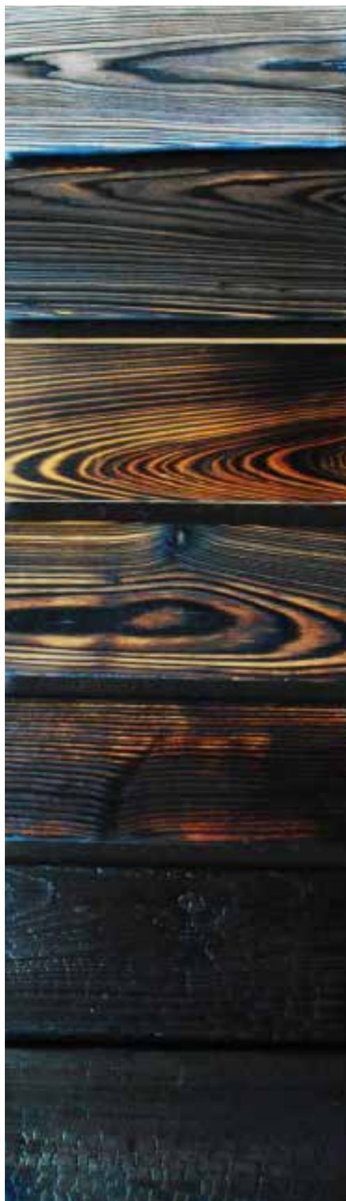
Fases de carbonización de la madera
