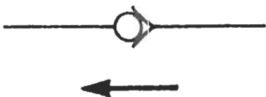
Fig. 44 (a). Símbolo simplificado de una válvula de retención. La corriente sólo puede fluir en la dirección de la flecha.
