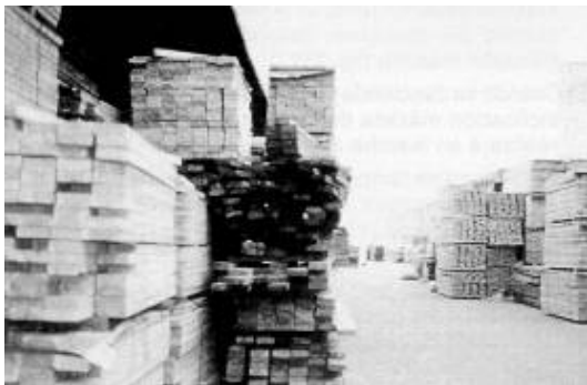
Fig. 2: Apilado incorrecto sobre un paquete semivaciado
