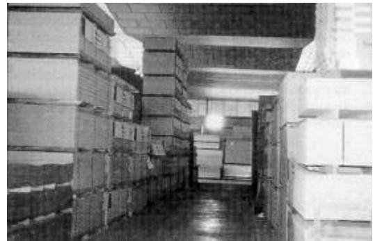
Fig. 6: Apilamiento de tableros con calzos en su base y en separación de paquetes
