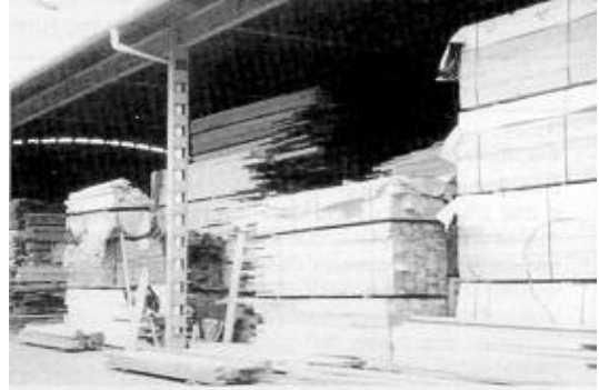
Fig. 5: Apilado de paquetes de tablones, con calzos en su base y en separación de paquetes
