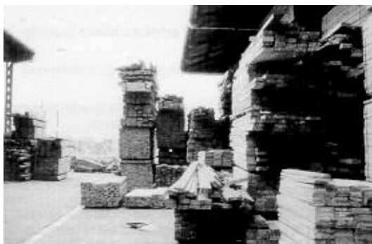
Fig. 2: Apilado incorrecto sobre un paquete semivaciado
