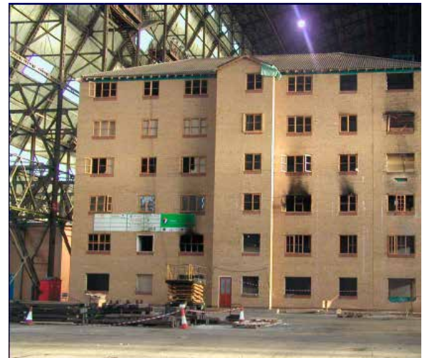
Ensayo a escala real llevado a cabo en los laboratorios del BRE en Cardington (Reino Unido, 2000) de un edificio de ELM de 6 plantas. Estos hangares eran anteriormente una base de dirigibles
