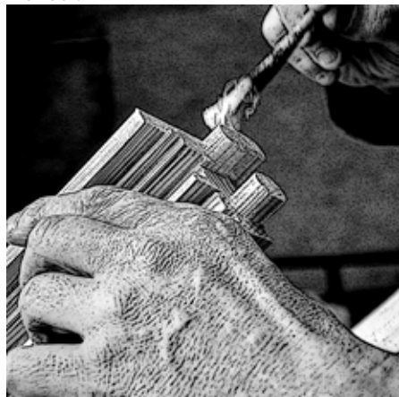
Encolado de espigas con brocha
