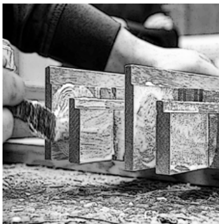
Encolado de horquillas con brocha
