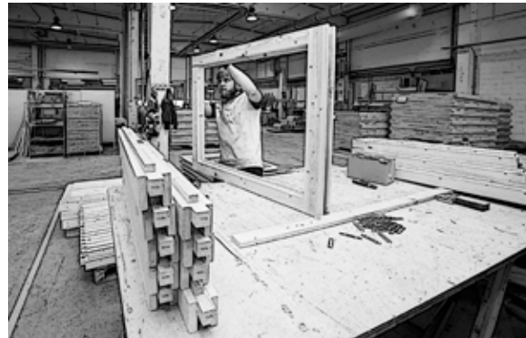
Montaje de cerco y hojas
