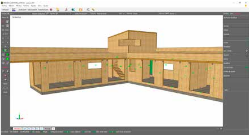
Imagen 5: Detalle del modelo con los números de producción/de montaje visibles en pantalla, de Escuadría.
