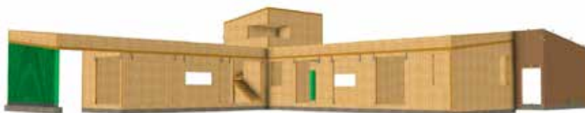
Imagen 3: Modelo 3D de la vivienda desarrollado en cadwork por Escuadría, con las geometrías preparadas para su exportación a CNC. Cada panel lleva sus capas exteriores orientadas en la dirección correcta, y las calidades de las capas exteriores están bien identificadas.
